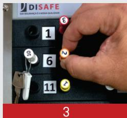
Para retirar qualquer chave, coloque o pino colorido ao lado da posição da chave que deseja retirar. Pressione e gire o pino colorido no sentido anti-horário. A chave será liberada, ficando o pino colorido preso ao quadro, identificando o utilizador que está com a chave.
